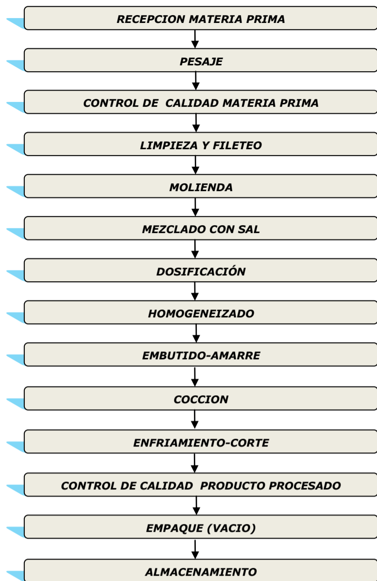
Figura 1. Diagrama de proceso para elaboración de chorizos y butifarras de pulpa de pez león ( Pterois volitans ).
